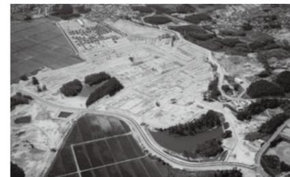
粗造成はほぼ完了し、一部細部造成も完了して分譲が始まっている。調整池・沈砂池及び残地森林・造成森林が観られる。(宮城県七ヶ浜町)
